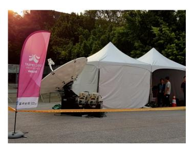
Globecast 的超高清衛星新聞採集設備透過亞洲五號衛星傳輸 4K 直播訊號
