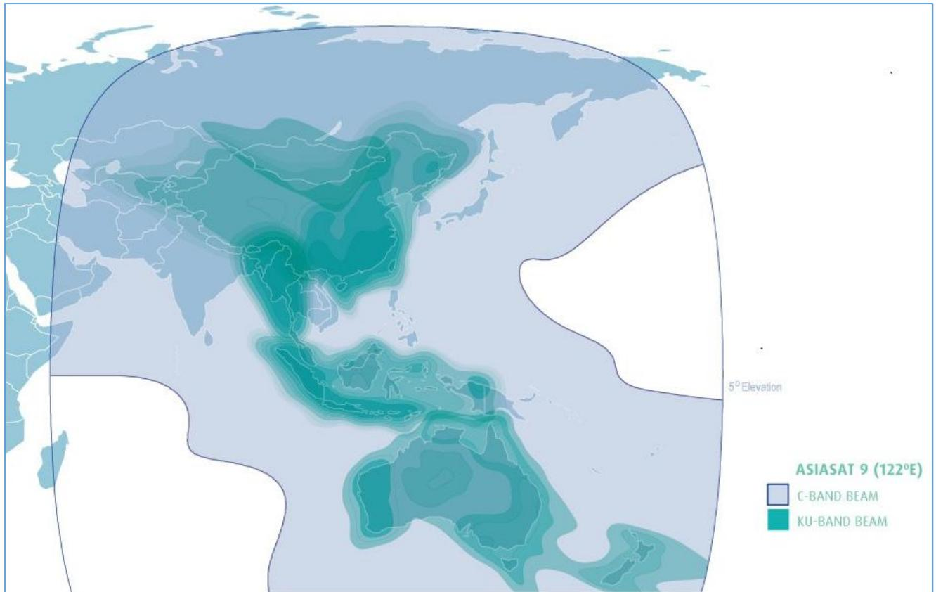
亞洲九號衛星載有多個 C、Ku及Ka波段轉發器，提供更強的功率、效益和彈性為亞太區服務
